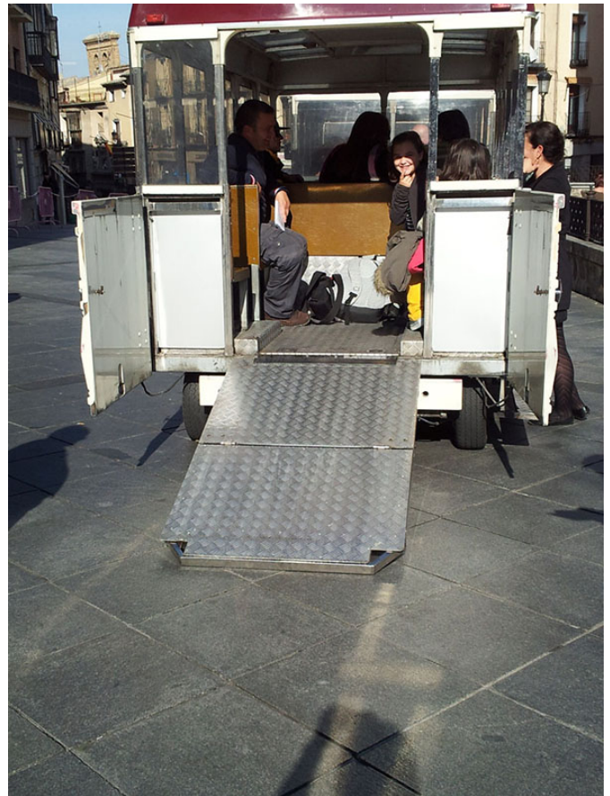
Rampa de acceso al tren
