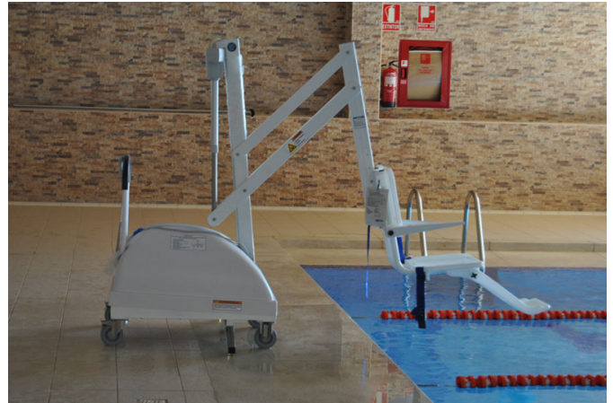
Piscina con grúa móvil
